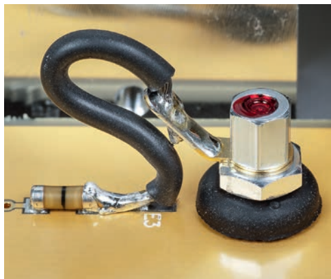
Nagra-typisch sitzen die Platinen zum Schutz vor Mikrofonie zwischen kleinen Gummidämpfern. Die Schweizer nennen dies „silence locked“.
